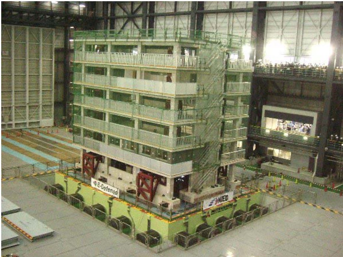
写真1 鉄筋コンクリート構造物(総重量1,000t) 破壊公開実験 (2006年1月 撮影：鏡原)
